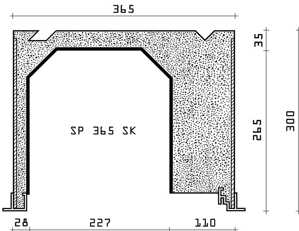
Serienmäßig haben alle Rolladenkästen der Typenreihe SP eine spezielle **Clip - Innenschiene** für den einfachen, schraublosen **EASY - CLIP - Deckelanschluss**, sowie eine Außenschiene, beide mit 15 mm Ausladung.
